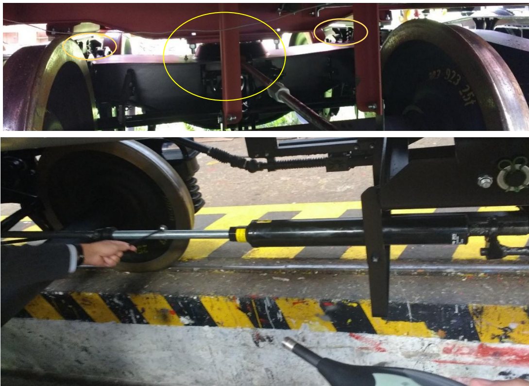
Obrázok 6. Priečník rámu podvozku s guľovým čapom a pripojenie brzdneho tiahla k priečníku (hore); tiahlo brzdnej sústavy spojené s priečníkom a plášťom nádrže cisterny.
