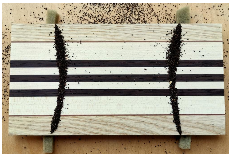
Obrázok 16. Kompozit z viacero drevín : Tangenciálno-radiálny rez – mód (2,0), f_4 = 405 Hz.
