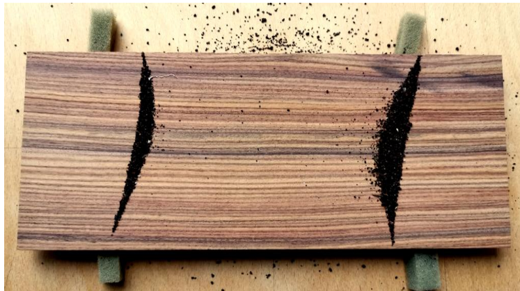
Obrázok 14. Santos : Radiálny rez – mód (2,0), f_4 = 439 Hz.
