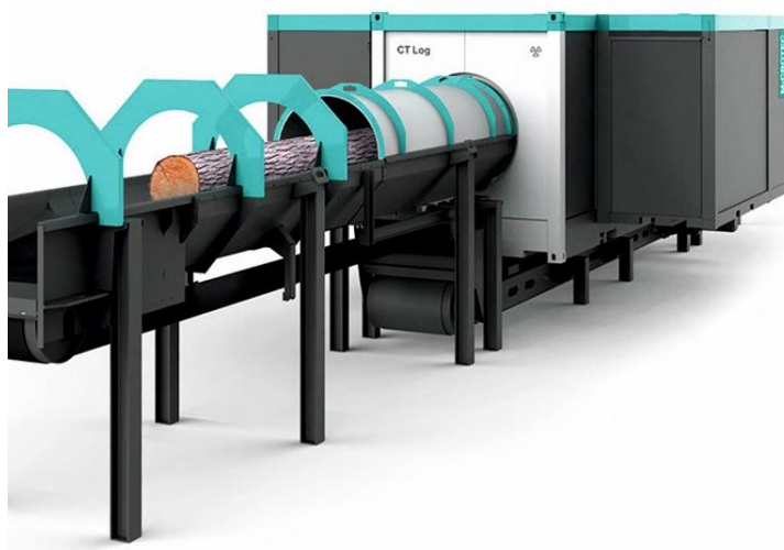
Obrázek 1. CT Log scanner. © Microtec (MICROTEC, 2019).
