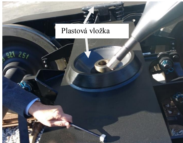
Obrázok 4. Priečnik rámu podvozku s plastovým lôžkom pre guľový čap a klznicu.
