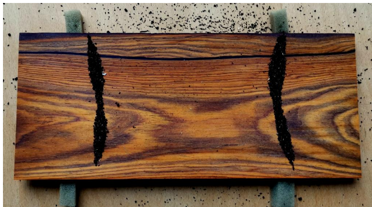
Obrázok 15. Cocobolo : Tangenciálny rez – mód (2,0), f_4 = 557 Hz.
