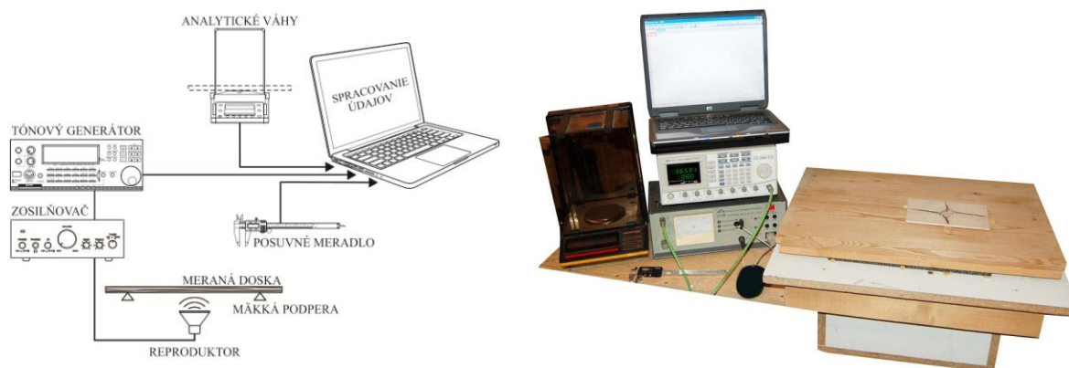
Obrázok 13. Bloková schéma a snímka aparatúry na meranie Chladniho obrazcov – VIBROVIZER.
