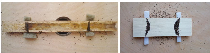
Obrázok 1. Doštička poškodená drevokazným hmyzom (smrek atakovaný črvotočom) a smreková doštička bez poškodenia a bez povrchovej úpravy.
